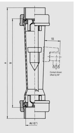
Fig. 3/81 SITRANS F VA Trogflux, dimensions
