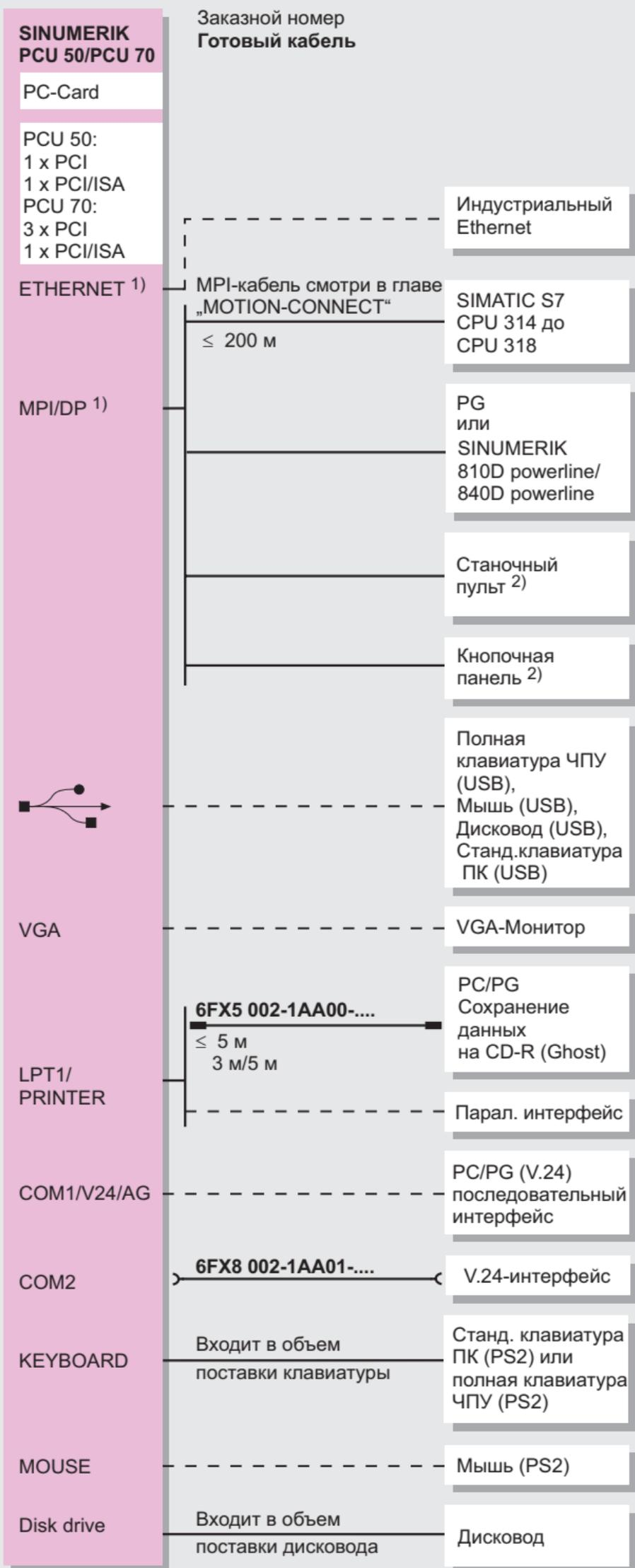
1) При использовании интерфейса ETHERNET в гнездо MPI/DP необходимо использовать кабель MPI с прямым (неизогнутым) штекером/отводом кабеля, иначе гнездо ETHERNET будет перекрыто (смотри главу “MOTION-CONNECT”).
