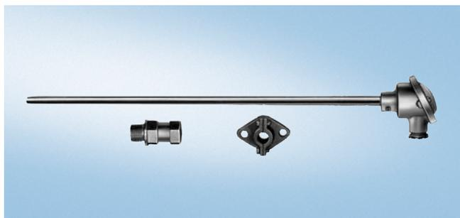
Термометр сопротивления для дымового газа с соединительной головкой подходит для диапазона температур -50 ... +600 °C и может поставляться также со встроенным измерительным преобразователем температуры.
